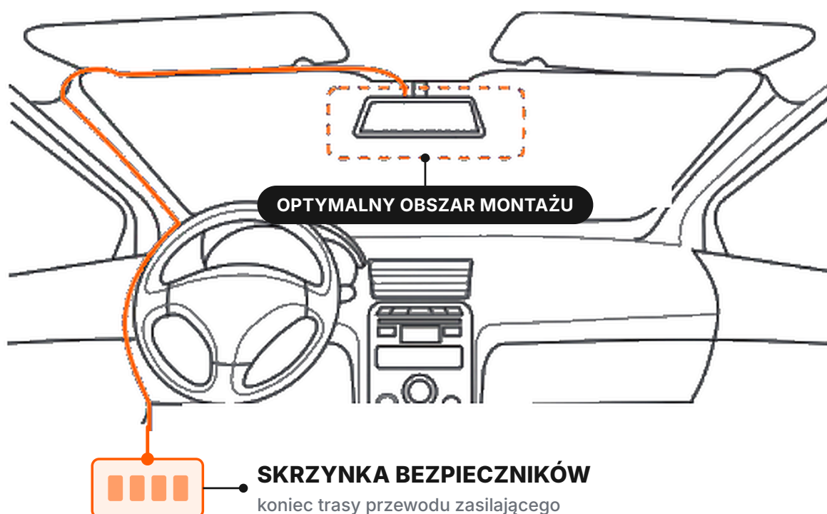
SCHEMAT PROWADZENIA PRZEWODU W SAMOCHODZIE
